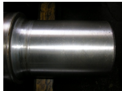
Рис. 6. Шийка осі колісної пари після накатування та шліфування
