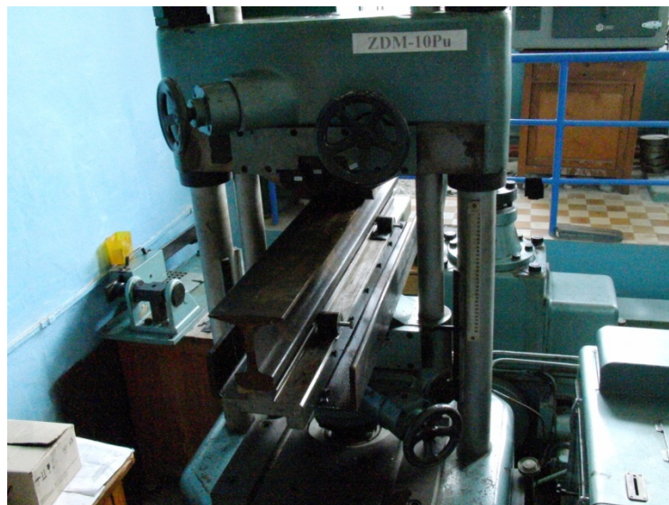
Рис. 4. Загальний вигляд випробувальної установки із встановленим за схемою № 2 зразком рейки
